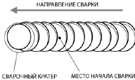
Рис. 8.1.2. Начало сварки при смене электрода.
