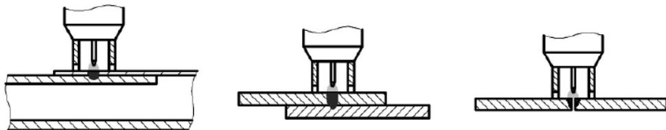
Рис. 9.14.2. Основные виды соединений при Spot сварке.
