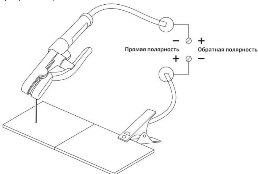
Рис. 11.2.1. Способы подключения.
