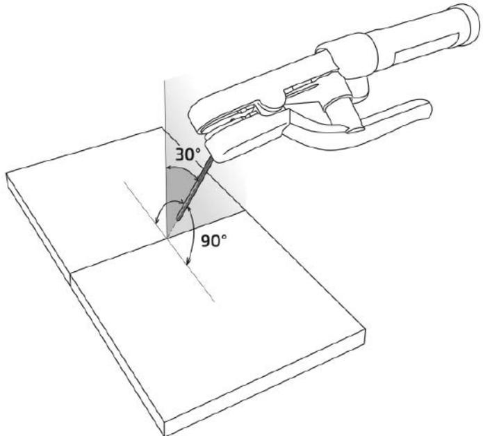
Углы наклона электрода при сварке углового соединения.
