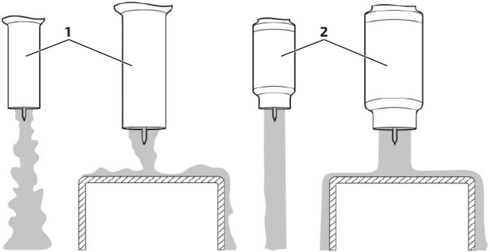
Рис. 9.8.1. Различие газового потока: обычное сопло и газовая линза.
