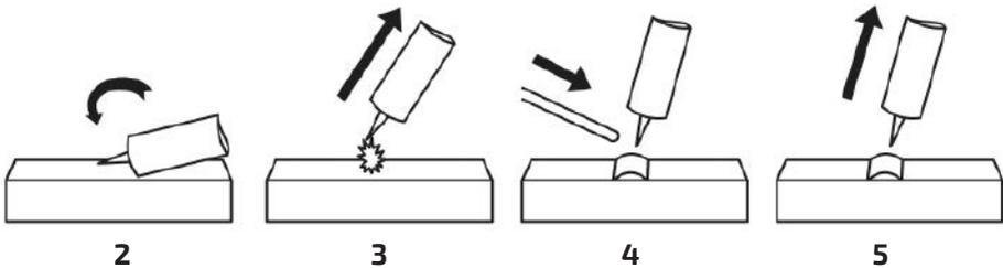
Рис. 9.6.2. Способ поджига дуги от сопла горелки.
