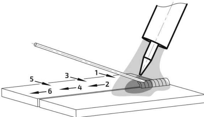
Рис. 9.9.2. Пример манипуляции присадочной проволокой при TIG сварке.
