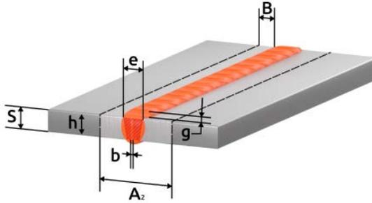
Рис. 12.0.1. Пример стыкового соединения.
