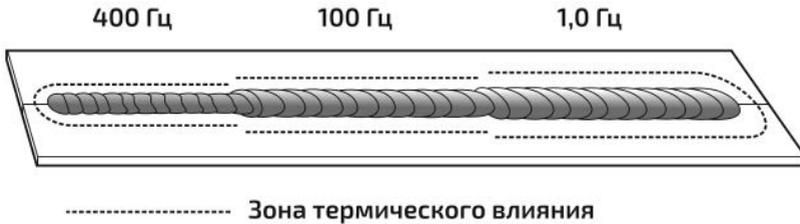
Рис. 9.11.3. Зависимость частоты импульса.
