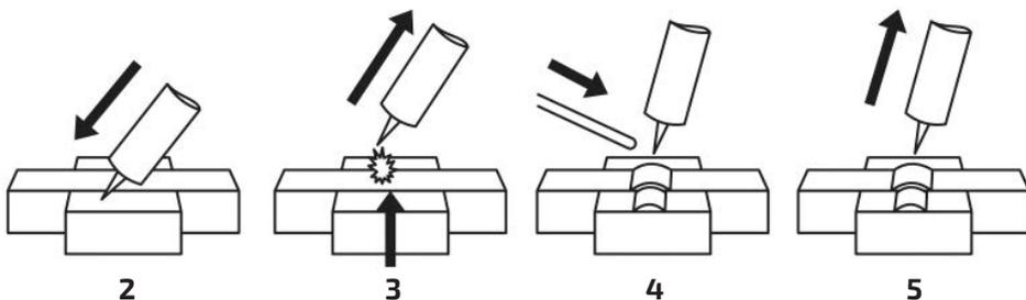
Рис. 9.6.4. Способ поджига дуги на выводной пластине.
