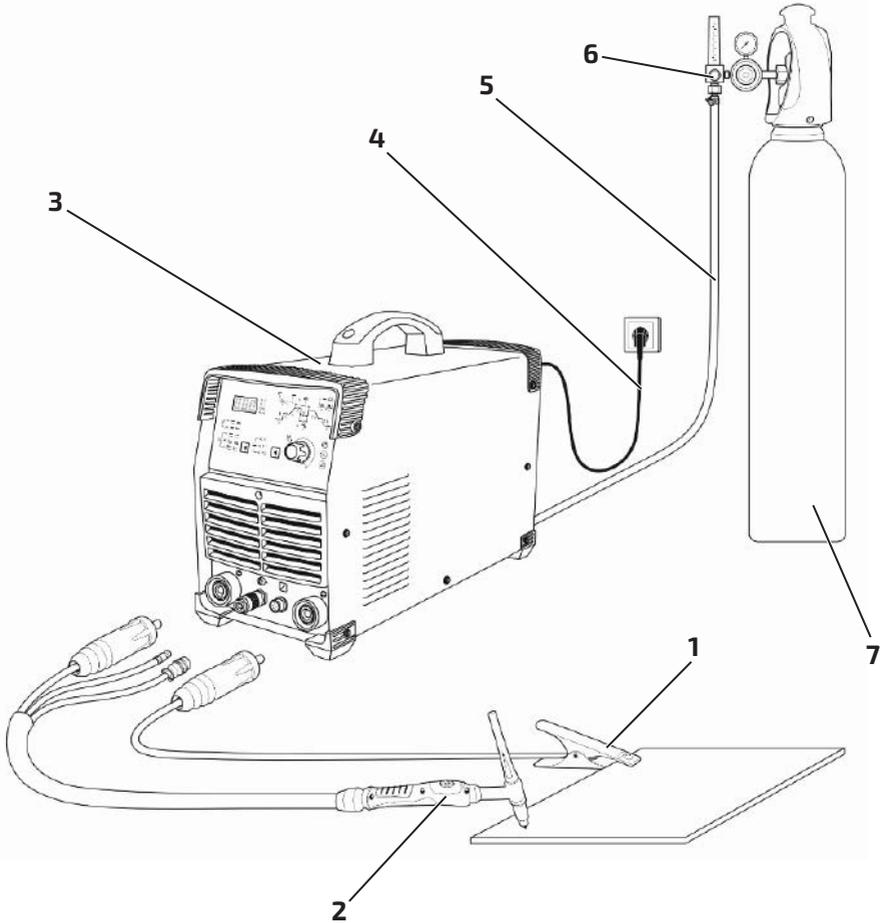
Рис. 8.0.1. Схема подключения оборудования с горелкой воздушного охлаждения.
