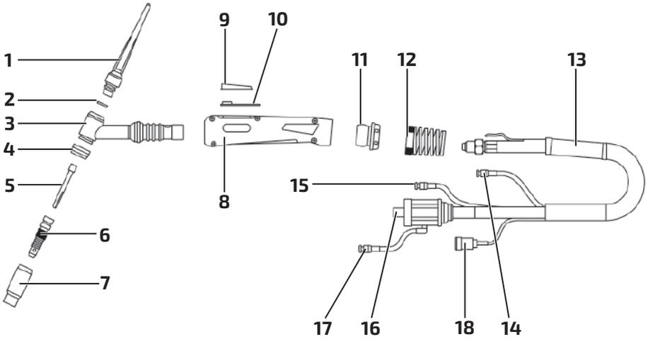
Рис. 9.3.2. Горелка для аргонодуговой сварки водяного охлаждения.
