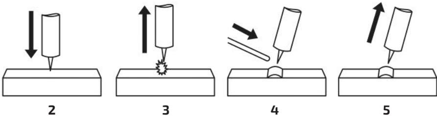
Рис. 9.6.1. Способ поджига дуги касанием.
