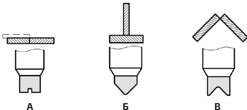
Рис. 9.14.3. Виды насадок в зависимости от типа сварных соединений.
