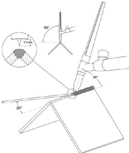
Рис. 9.10.4. Угловое внешнее соединение.
