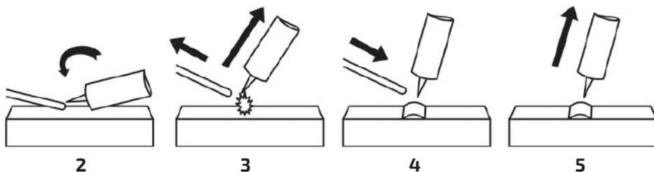
Рис. 9.6.3. Способ поджига дуги от присадочного прутка.
