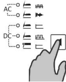
4. Кнопка (см. табл. 7.0.1. поз. 6, п. 4) предназначена для выбора параметра и возврата в доп. меню.
