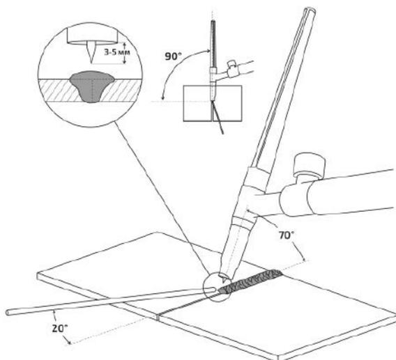
Рис. 9.10.1. Стыковое соединение.
