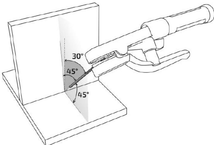
Рис. 11.1.3. Угол наклона электрода.
