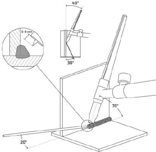
Рис. 9.10.3. Угловое внутреннее соединение.
