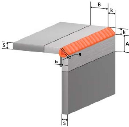
Рис. 12.0.3. Пример углового соединения.
