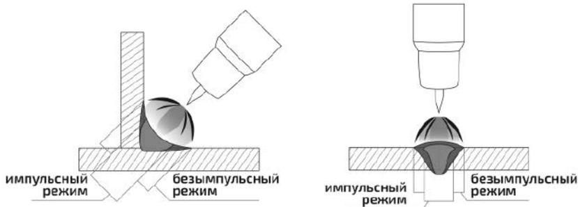
Рис. 9.11.1. Выделяемое тепло в импульсном и безимпульсном режимах.
