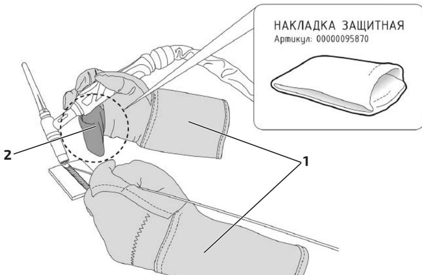
Рис. 8.2.1. Перчатки и накладка защитная для TIG сварки.
