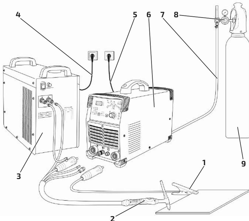
Рис. 8.0.2. Схема подключения оборудования с водяным охлаждением.
