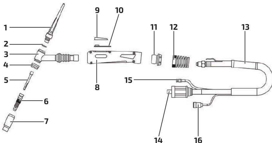
Рис. 9.3.1. Горелка для аргонодуговой сварки воздушного охлаждения.
