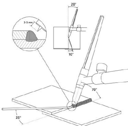
Рис. 9.10.2. Нахлесточное соединение.
