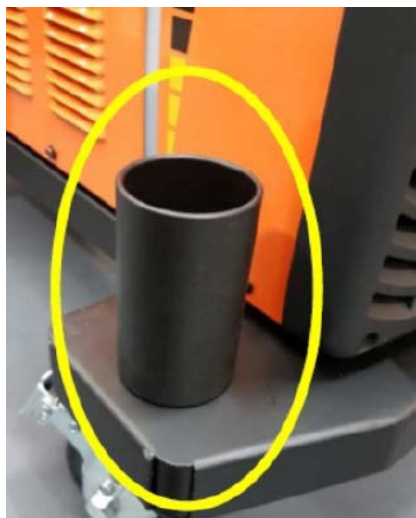
Фото 7.7. Установка стакана для присадочной проволоки.
