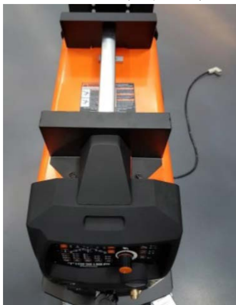
Фото 7.11. Установка кронштейнов полки тележки.
