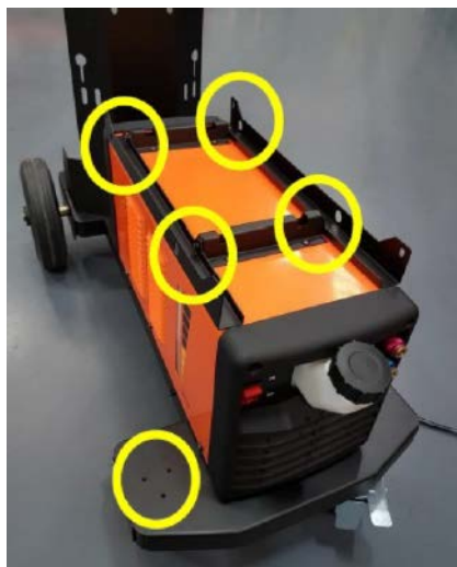
Фото 7.6. Установка кронштейнов источника.
